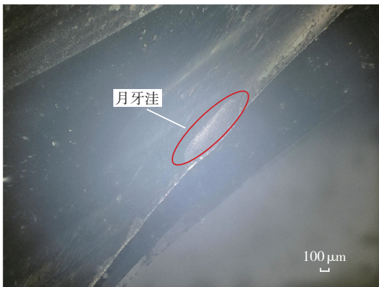
图3 月牙洼磨损形貌
